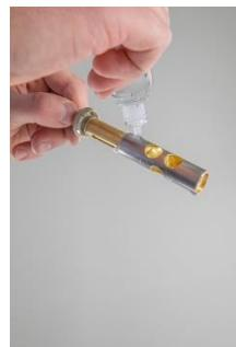
Durch das Drehen verteilt sich das Fett gleichmäßig auf dem Innenzug. Wiederholen Sie dies mit dem zweiten Zugrohr. Anschließend stecken Sie den kompletten Zug in das Instrument zurück und entfernen eventuell überschüssige Fettreste.
